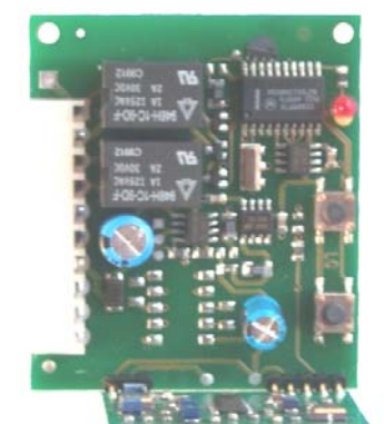
Fig. 4 - RICEVENTI RADIO A SCHEDA (1 CH-2 CH) - RADIO RECEIVER CARD (1 CH-2 CH) - RECEPTEUR RADIO A FICHE (1 CH- 2 CH)
