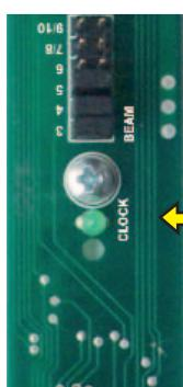
**LED CLOCK** lampeggiante = funzionamento corretto
