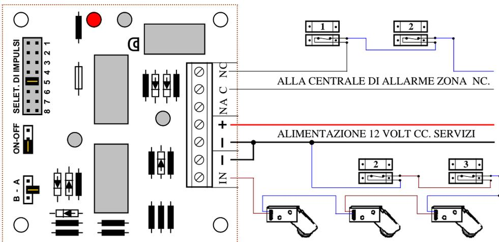
ESEMPIO DI COLLEGAMENTO SU UNA CENTRALE DI ALLARME VIA RADIO, TRAMITE IL MODULO AMPLIFICATORE SE-RCS IL QUALE LO RENDE FUNZIONALE CON LA NOSTRA CENTRALE DI ALLARMESH-D5R, E NE REGOLA LE FUNZIONI, IL CONTEGGIO DEGLI IMPULSI.
