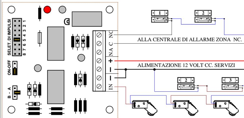
ESEMPIO DI COLLEGAMENTO SU UNA CENTRALE DI ALLARME VIA RADIO, TRAMITE IL MODULO AMPLIFICATORE SE-RCS IL QUALE LO RENDE FUNZIONALE CON LA NOSTRA CENTRALE DI ALLARMESH-D5R, E NE REGOLA LE FUNZIONI, IL CONTEGGIO DEGLI IMPULSI.
