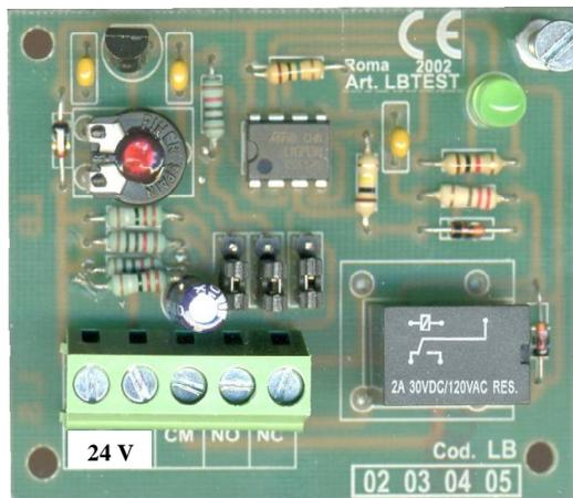
**SS-LBV** Circuito per il controllo **carica della batteria**. Controlla solo la soglia **bassa** della batteria in tampone, **sensibilità regolabile** tramite trimmer. Jumper di programmazione per l'intervento del relè. Attenzione il circuito è già tarato e programmato, non toccare. Alimentazione 24 V. Relè 1 scambio 5 A 24 V. **Compatibile con qualsiasi tipo e marca di batteria**. Dimensioni L62XL52XH14 mm. Peso 31 gr.
